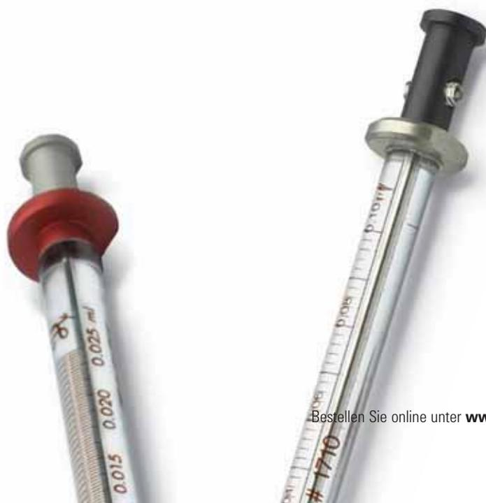
Mit GC PAL Flüssigkeitsinjektionsspritzen kann eine Vielzahl verschiedener Probenvolumina injiziert werden, bei LVI-Anwendungen bis zu 500 µL.
